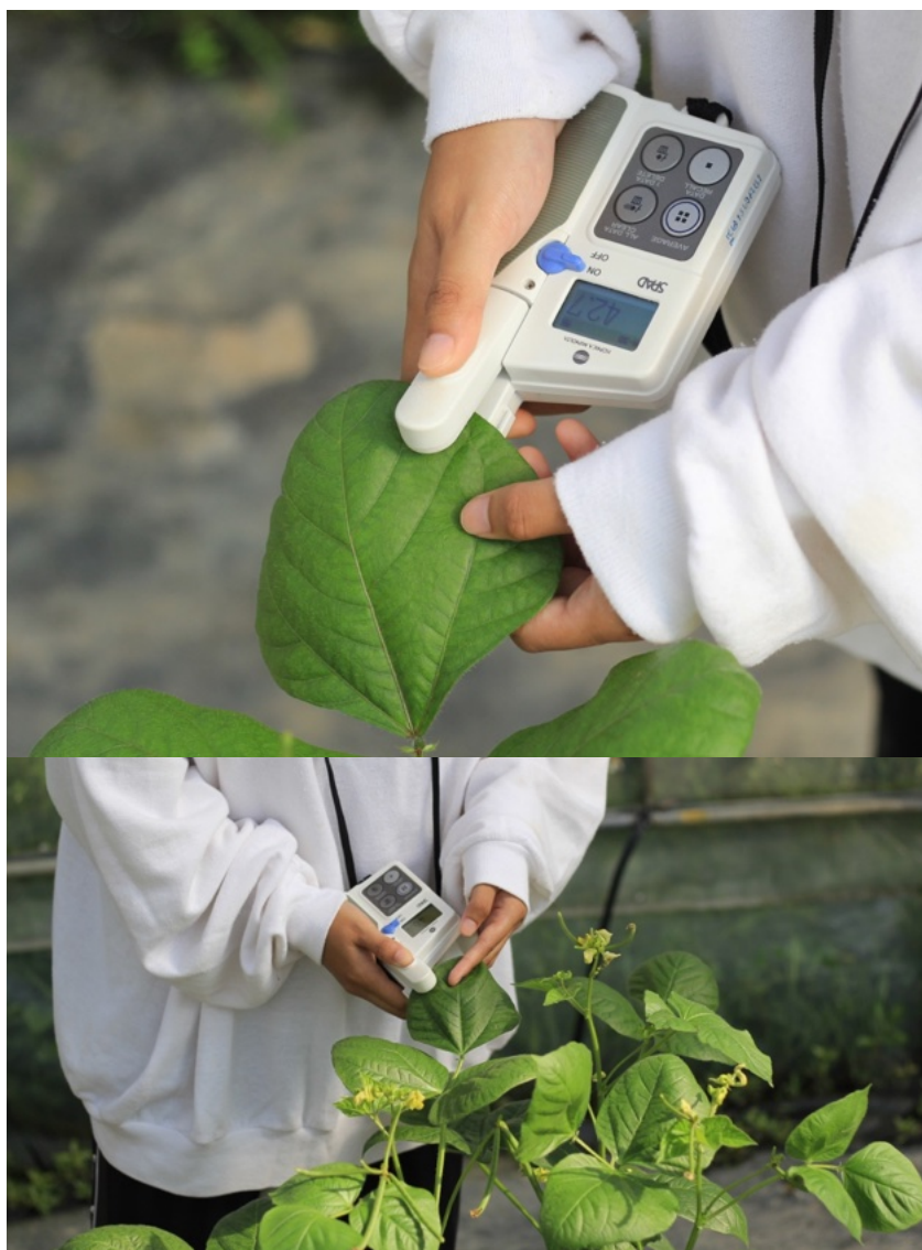
ภาพที่ 5 การวัดคลอโรฟิลล์ ปริมาณเครื่องวัดคลอโรฟิลล์ chlorophyll meter SPAD-502Plus ยี่ห้อ Konnica Milnolta ที่ระยะ V4 R1 R2 และ R4
